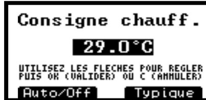
Figure 55. Écran de réglage de la température de l'eau
