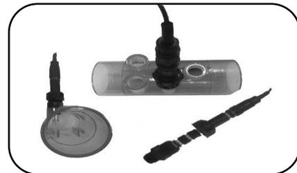
Figure 14. *Montage des portes-sondes et de la sonde redox*
