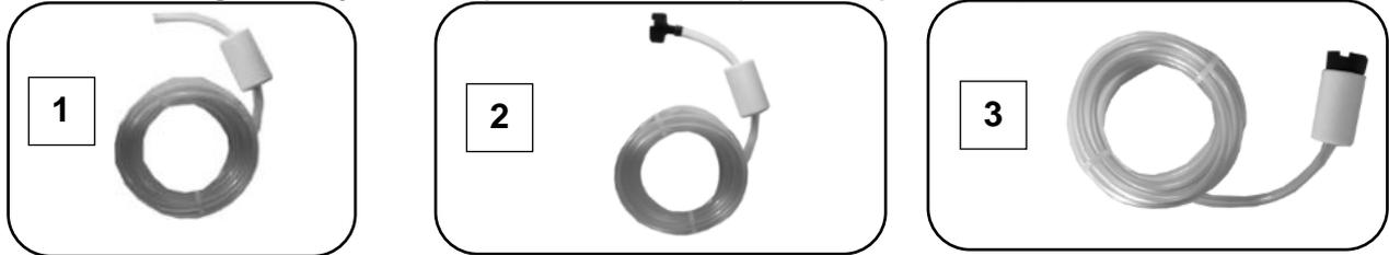
Figure 19. Montage de la crépine d'aspiration
