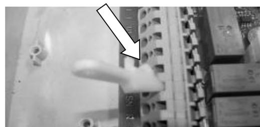
Insérer l'outil en respectant le sens d'insertion. Un petit bruit permet d'identifier que l'outil est bien inséré.
