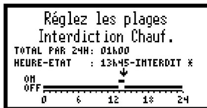
Figure 60. Configuration de l'interdiction chauffage
