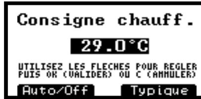
Figure 59. Écran de réglage de la température de l'eau
