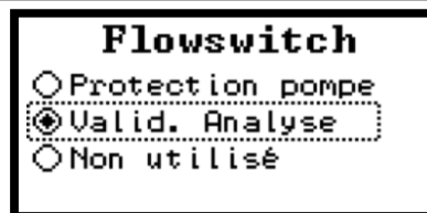
Figure 49. Configuration du flowswitch en mode valid analyse
