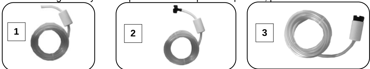
Figure 17. Montage de la crépine d'aspiration
