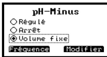
Figure 43. réglage du volume et de la fréquence d'injection
