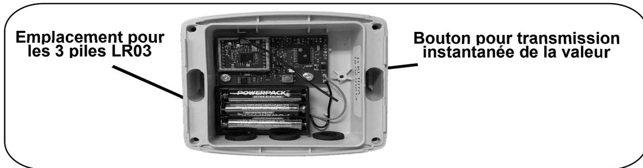
Figure 32. Capteur température d'air
