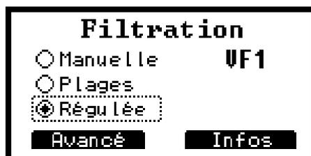
Figure 12. Écran de réglage du mode régulée
