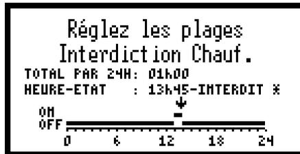
Figure 52. Configuration de l'interdiction chauffage
