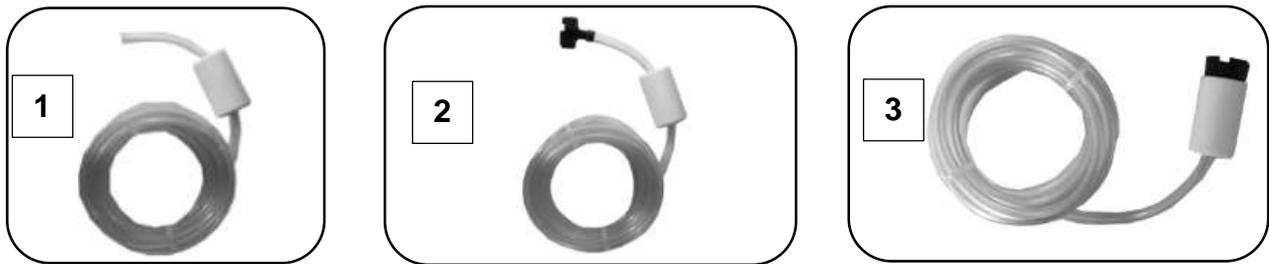
Figure 19. montage de la crépine d'aspiration
