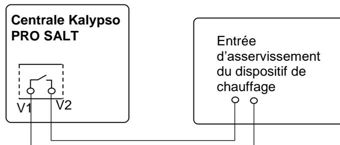
Figure 28. *Branchement du chauffage*
