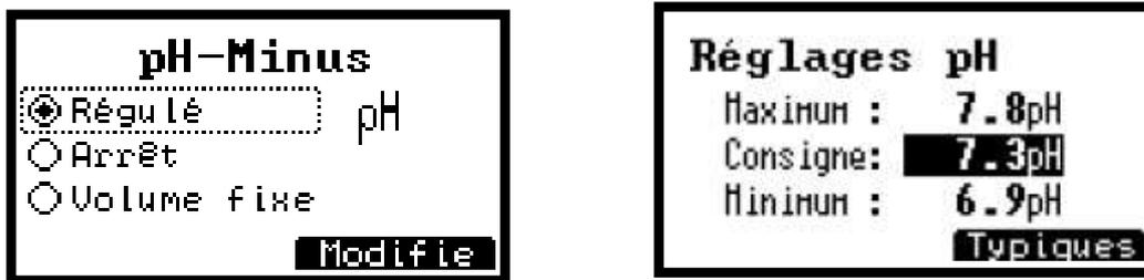
Figure 43. Réglage de la consigne et des seuils d'alerte pH
