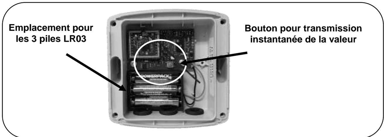
Figure 33. Capteur température air
