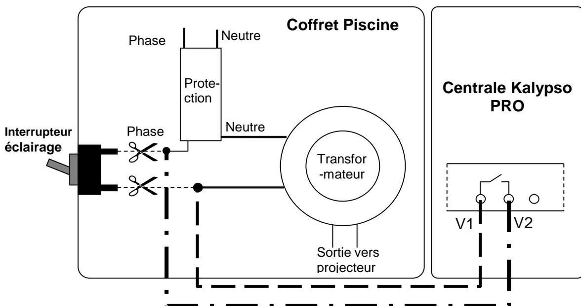
Figure 29. *Exemple de câblage de l'éclairage avec un coffret existant*
