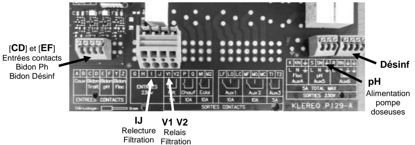
Figure 25. Branchement des entrées sorties de la centrale Kalypso PRO
