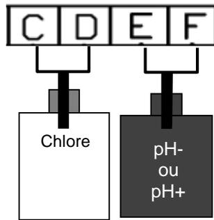
Figure 34. Branchement des détecteurs de fin de bidon
