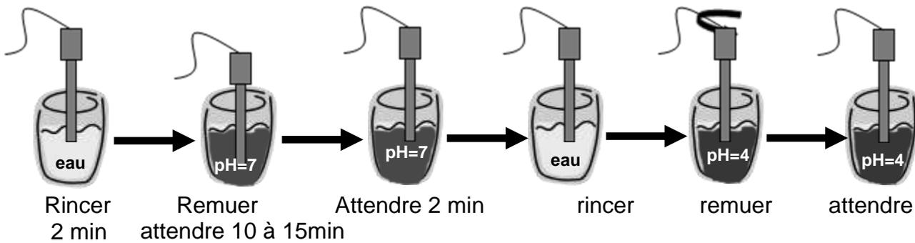
Figure 58. Calibration de la sonde pH
