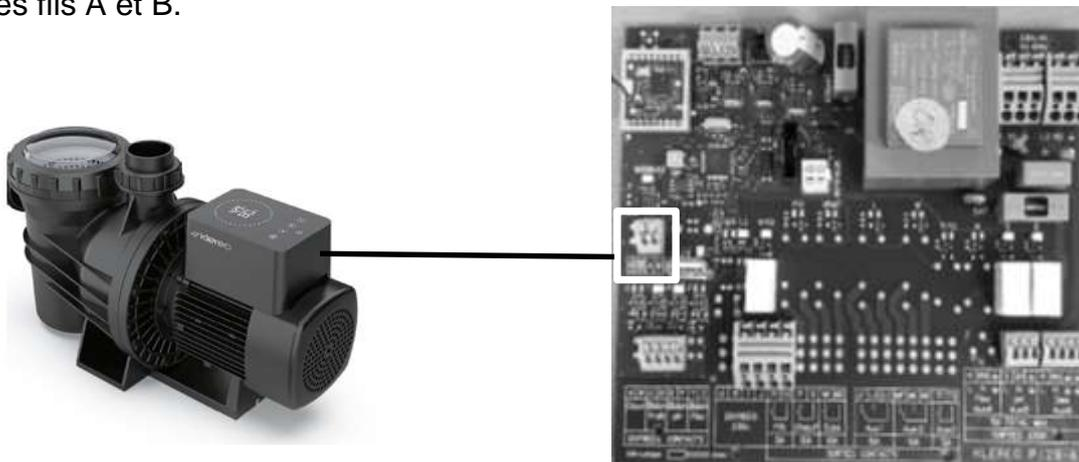
Figure 31. *Branchement du bus de communication Klereo Flo*
