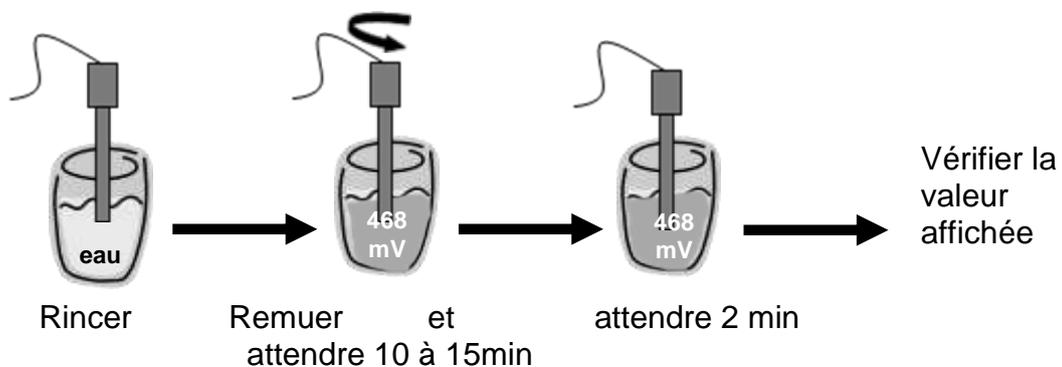
Figure 59. Vérification de la sonde Redox
