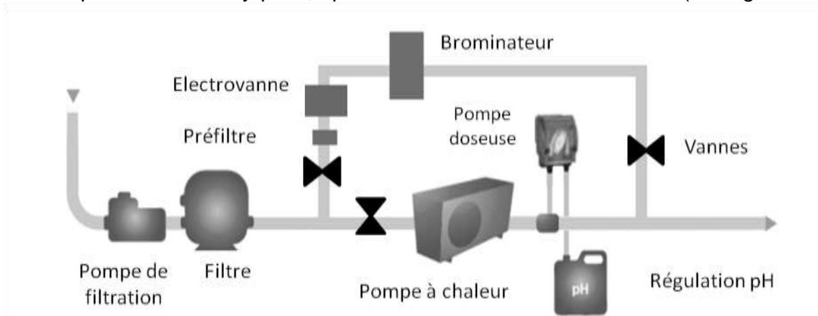
Figure 22. Installation du kit « régulation brome » 1<sup>ère</sup> possibilité
