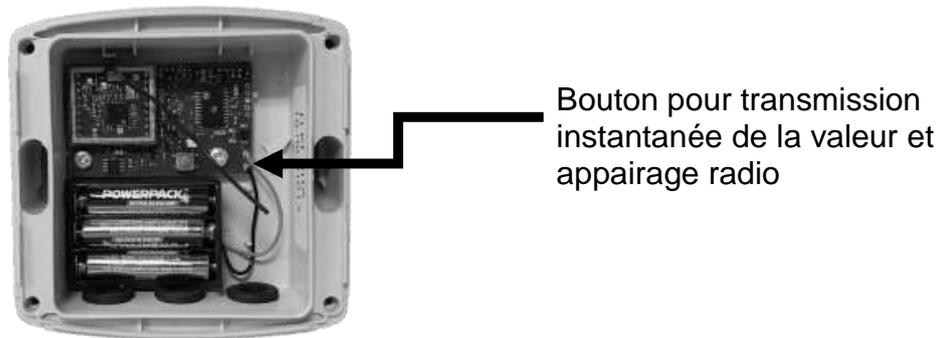
Figure 46. Capteur température air
