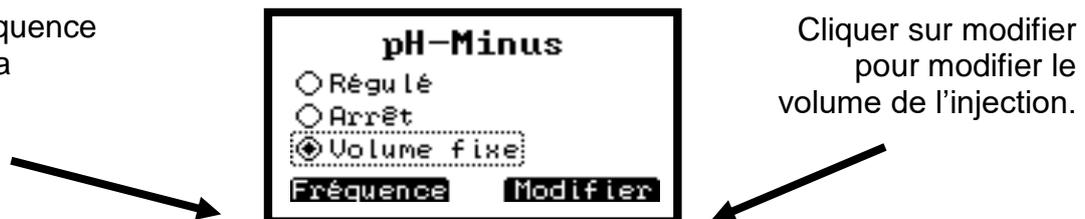
Figure 44. réglage du volume et de la fréquence d'injection
