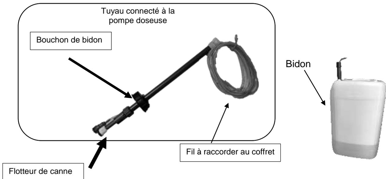
Figure 20. Montage Canne d'aspiration
