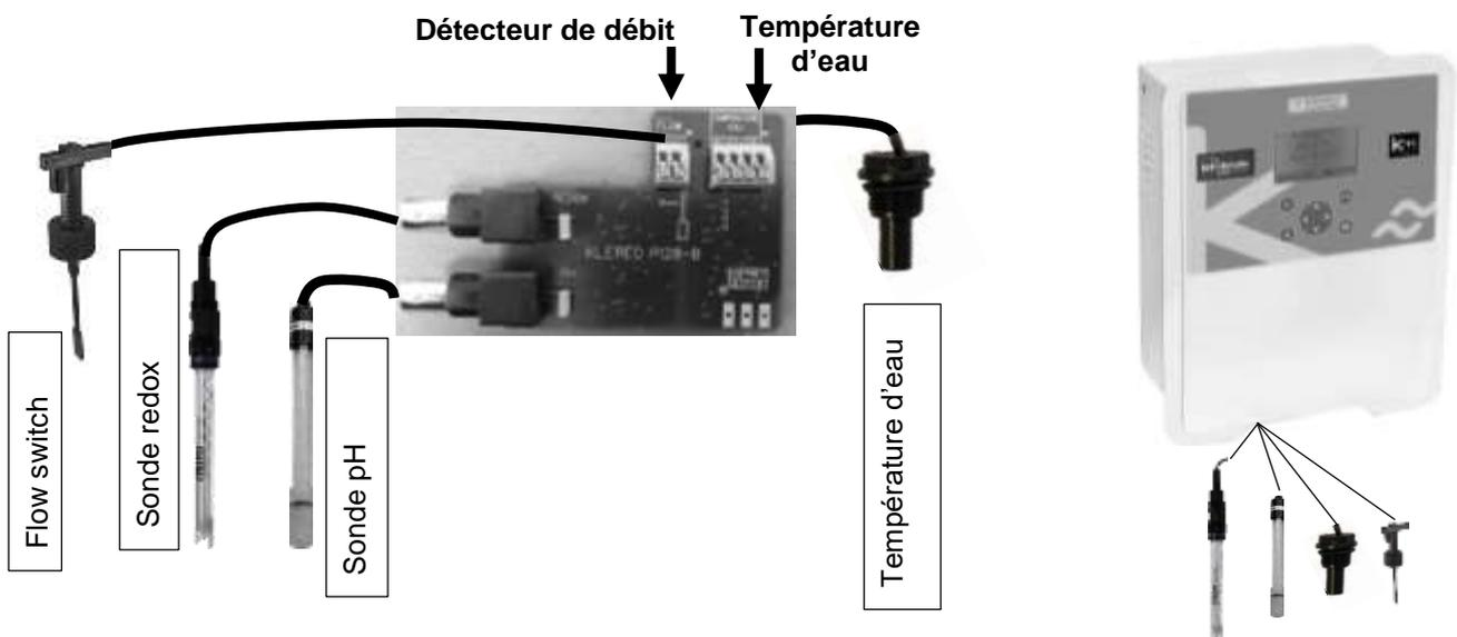
Figure 24. Branchement des capteurs sur la centrale Kalypso PRO
