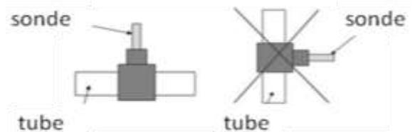
Figure 14. *Montage des sondes*
