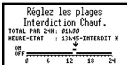
Figure 39. Configuration de l'interdiction chauffage
