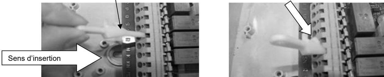
Insérer l'outil en respectant le sens d'insertion. Un petit bruit permet d'identifier que l'outil est bien inséré.
